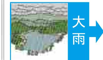
ため池の水位が上昇し堤防を越流したり、堤防が不安定な状態になり、ため池が決壊する危険性が高まります。
